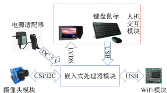
图1 “CV-Innovator”的硬件结构示意图
