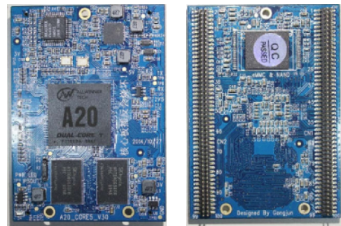
图2 全志 A20 嵌入式处理器核心板
